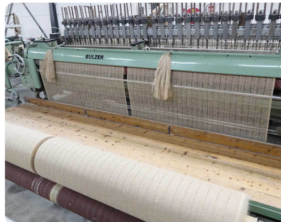
Zakład produkcyjny Zwartza mieści pokaźną liczbę krosien, które każdego dnia produkują szeroką gamę wyrobów z juty o szerokości od 3 do 520 cm.
