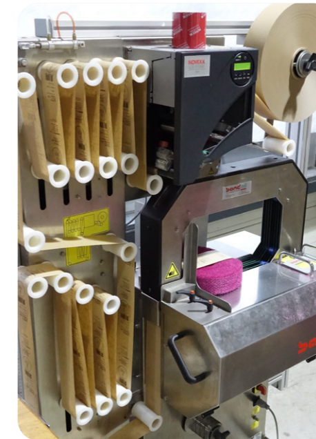
Maszyny banderolujące z systemem buforowym (po lewej) zapewniającym ciągłość procesu banderolowania.
